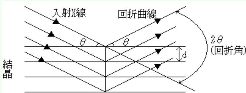
Fig.1 結晶によるX線の回折
