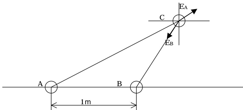
A 点が正の電荷  $Q_A$ , B 点が負の電荷  $Q_B$  であり, C 点に正の単位電荷があるとすると, ベクトルである電場は, A 方向  $E_A$  が外向き, B 方向  $E_B$  が B 点向きである。
